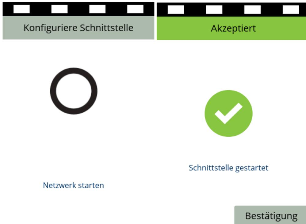
Nach der Bestätigung von DNS 2 speichert das Terminal die Einstellungen und zeigt im Ergebnis, ob die Schnittstelle nach der Logikprüfung gestartet werden kann.
