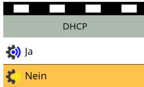
DHCP steht für Dynamic Host Configuration Protokoll, kurz erklärt für die automatische IP-Adressenverwaltung in einem Netzwerk. Da der automatische Bezug zuvor fehlgeschlagen ist, besteht entweder keine Verbindung zum Netzwerk oder es muss eine feste IP-Adresse hinterlegt werden.
